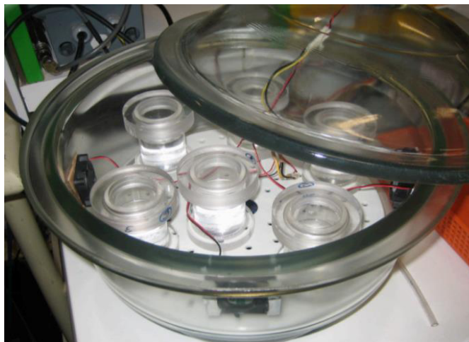
Figura 14. Sistema laboratorial para a determinação do valor de permeabilidade ao vapor de água.
