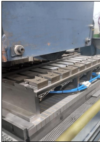
Figura 58 - Ferramenta finalizada montada na retificadora
