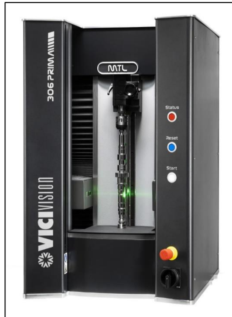
Figura 21 -Máquina de medição por visão (ViciVision)
