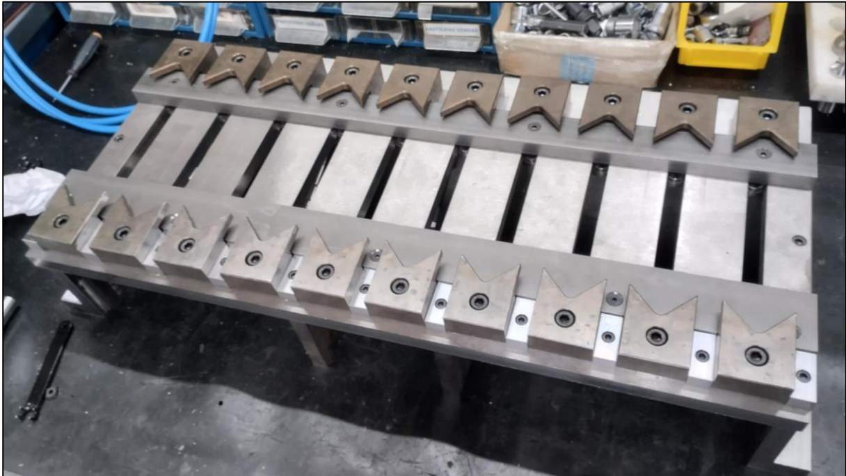
Figura 56 - Ferramenta com mordentes fixos montados
