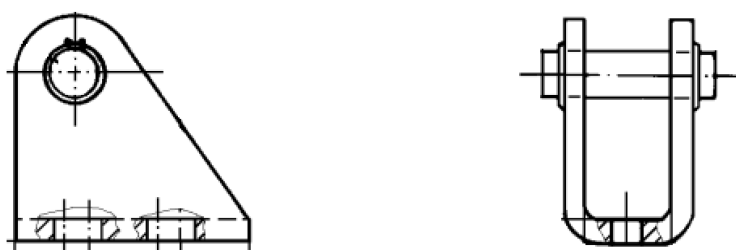
Figura 37 - Acessório de montagem ( Rear Clevis Bracket )
