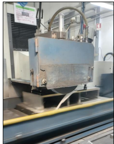
Figura 50 - Retificação final da base na retificadora plana
