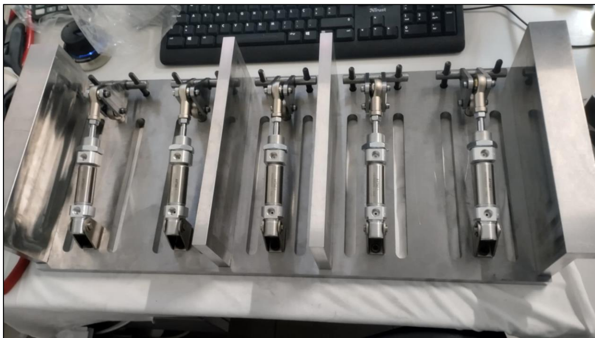
Figura 54 - Cilindros pneumáticos montados
