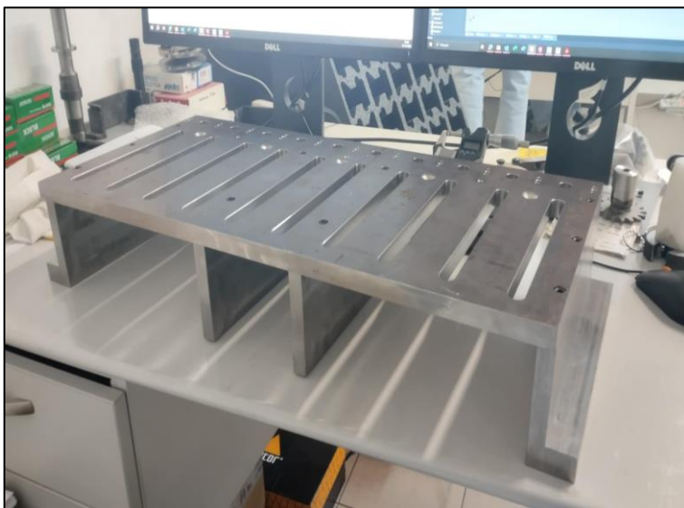
Figura 49 - Bases montadas antes da retificação final
