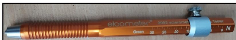
Figura 31. Medidor de dureza Erichsen sclerometer 3092 hardness tester
