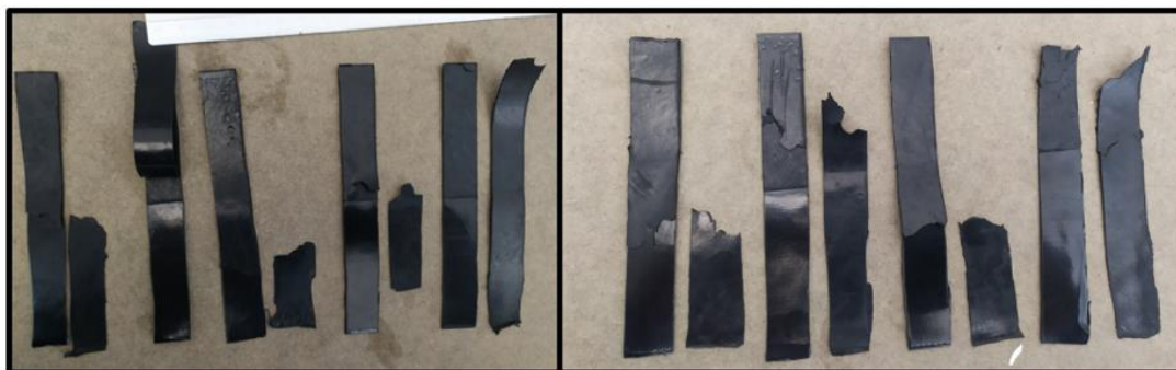
Figura 54. Amostras após realizado o peel test em PC/ABS com TPU; 1ª imagem: velocidade 200mm/s; 2ª imagem: velocidade 500mm/s
