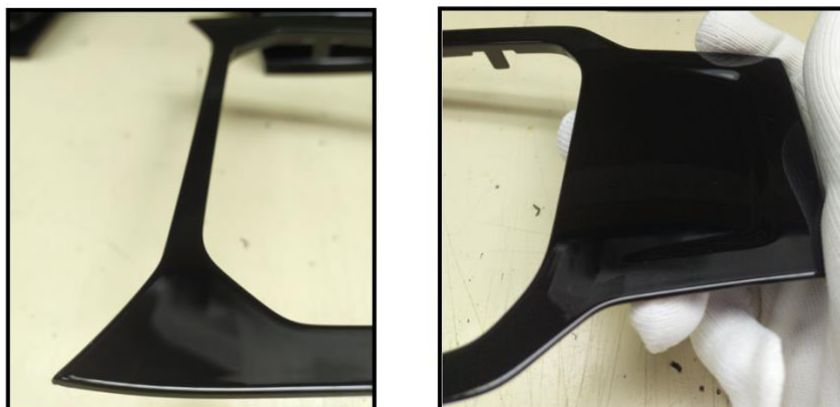
Figura 48. Aparência superficial de um substrato após ser colocado numa estufa no ensaio de resistência a cremes
