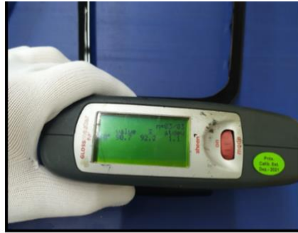
Figura 26. Medição de brilho com o equipamento Glossmaster Sheen Instruments de uma peça com alto brilho
