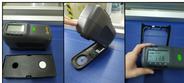
Figura 27. 1ª imagem - calibração do espectrofotômetro x-rite ; 2ª imagem - ponto de medição do espectrofotômetro; 3ª imagem – medição da cor de uma peça com alto brilho
