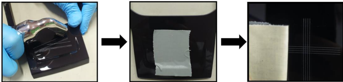
Figura 30. Etapas do teste de aderência cross-cut
