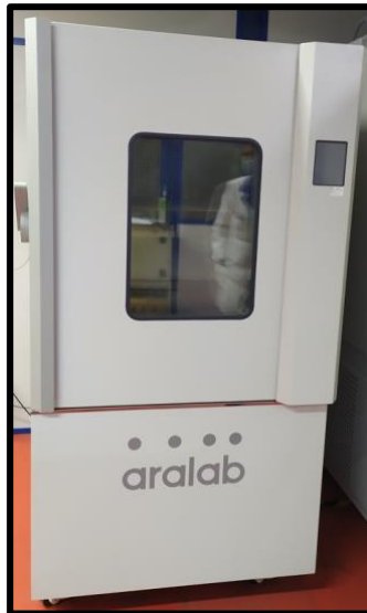
Figura 33. Câmara climática aralab
