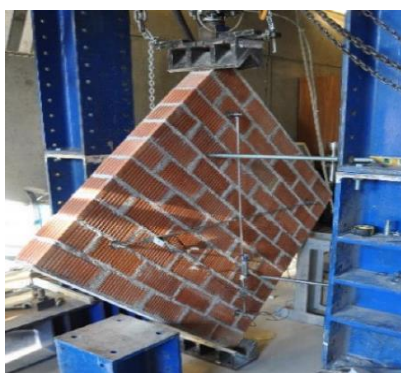
Figura 67 - a) Configuração dos ensaios de compressão diagonal, b) gráfico tensão-extensão (Aşikoğlu et al., 2021)
