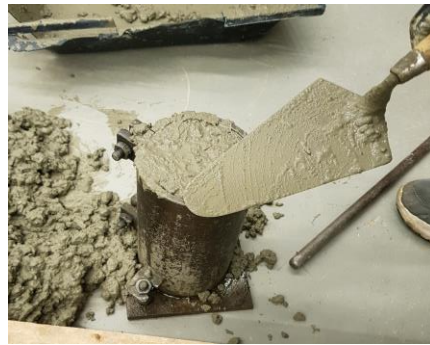
Figura 60 - Preparação dos provetes de betão
