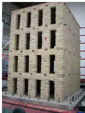
Figura 72 - Modelo experimental em alvenaria de pedra e pavimentos em madeira (Mendes et al., 2010)
