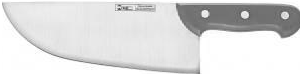
Figura 2.1 Cutelo utilizado no corte e desmanche de carne (adaptado de [8]).
