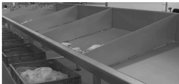
Figura 2.11 – Contentor metálico por baixo do transportador aéreo (adaptado de [12]).
