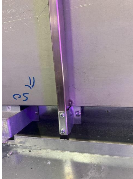
Figura 44: Barras verticais soldadas ao depósito.
