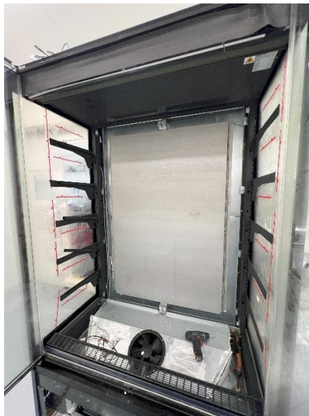
Figura 41: Depósito de água instalado na parte traseira interior do equipamento.
