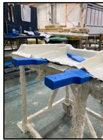
Figura 28. Cunhos inseridos na peça
