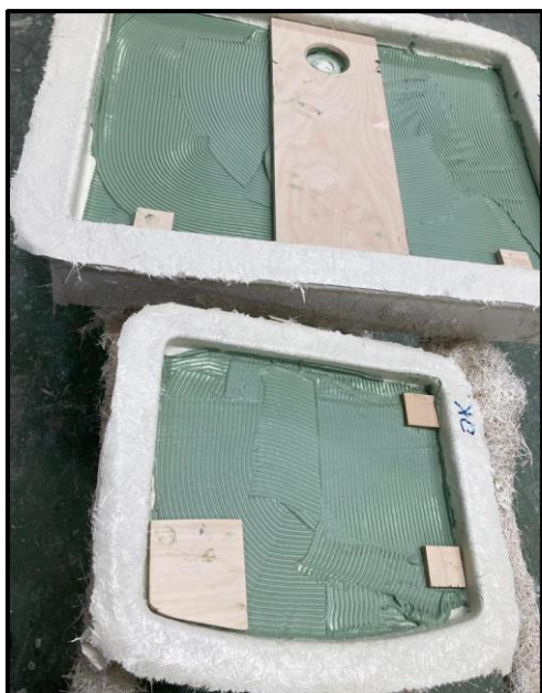
Figura 23. Aplicação da pasta e madeiras
