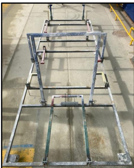
Figura 41. Carrinho com suportes ajustáveis
