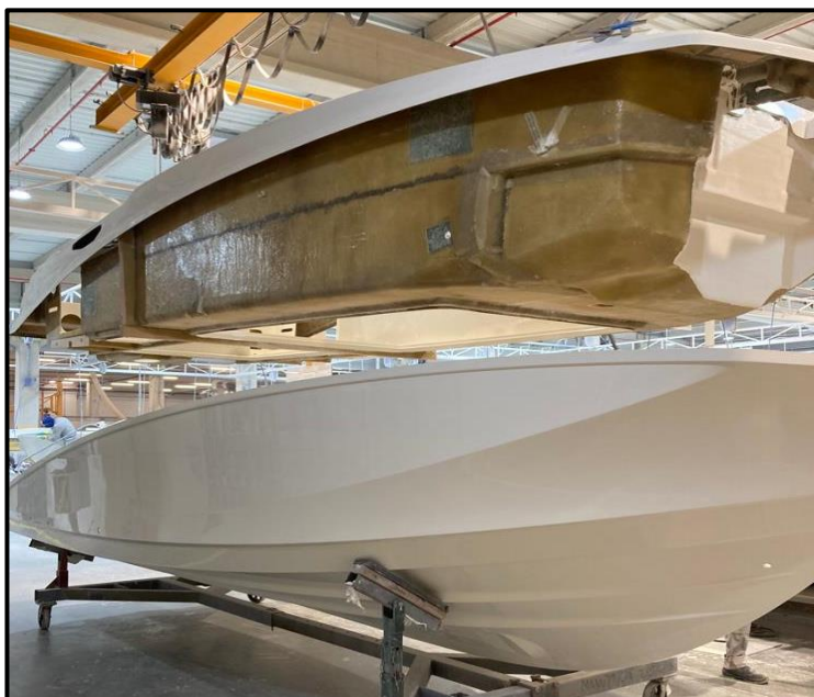
Figura 9. Casco (em baixo); Coberta (em cima)
