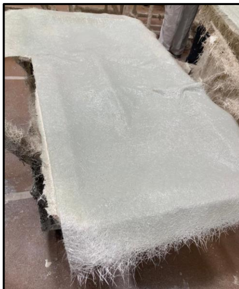
Figura 25. Aplicação de tiras de fibra sobre a peça
