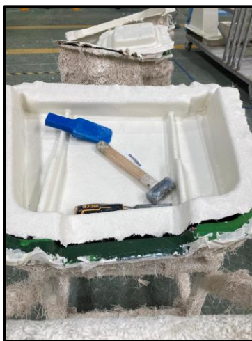
Figura 26. Cunho e martelos para o desmolde
