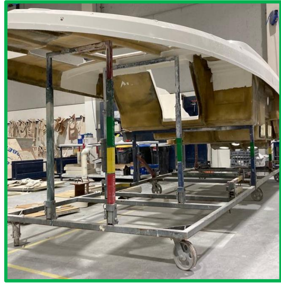
Figura 65. Suportes ajustáveis com marcação - Depois
