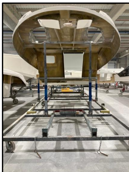
Figura 42. Carrinho com suportes ajustáveis para a coberta do modelo 755CR
