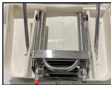
Figura 15. Escada montada na plataforma
