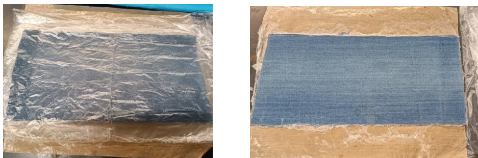
Figura 56 - Amostra DenimHDPE antes e após compressão (da esquerda para a direita) Fonte: Autora, arquivo pessoal
