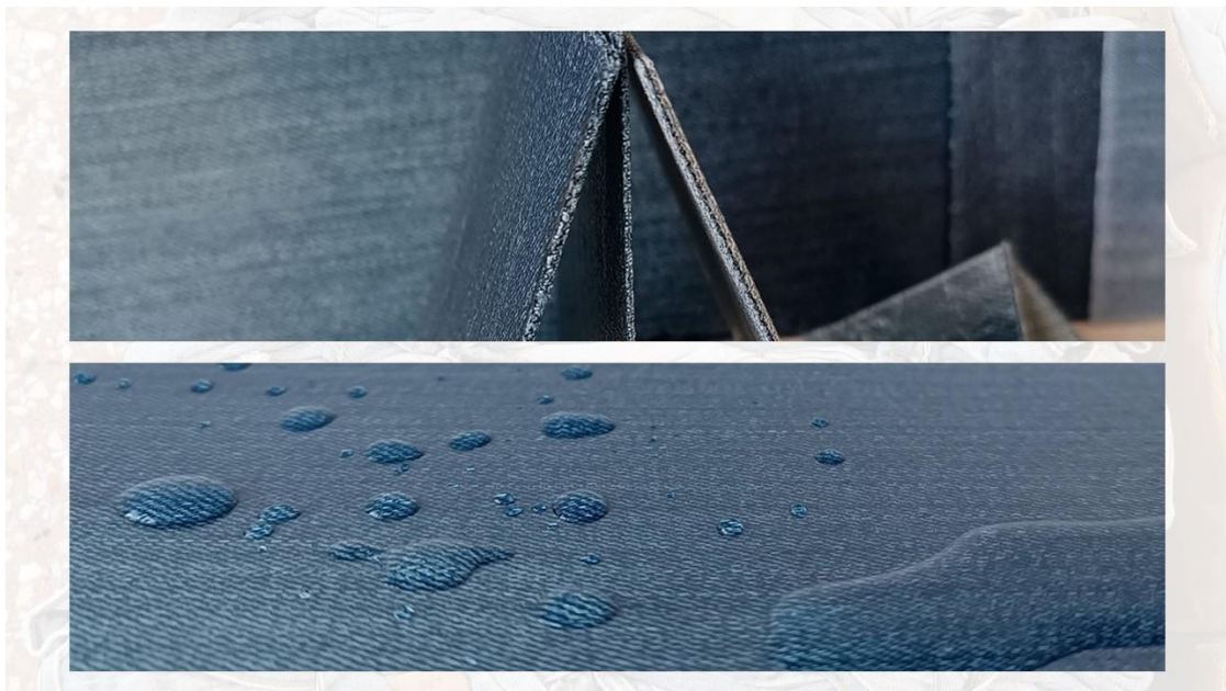
Figura 96 - Detalhe do material DenimPMMA (quanto à maleabilidade e permeabilidade à água) Fonte: Autora, arquivo pessoal
