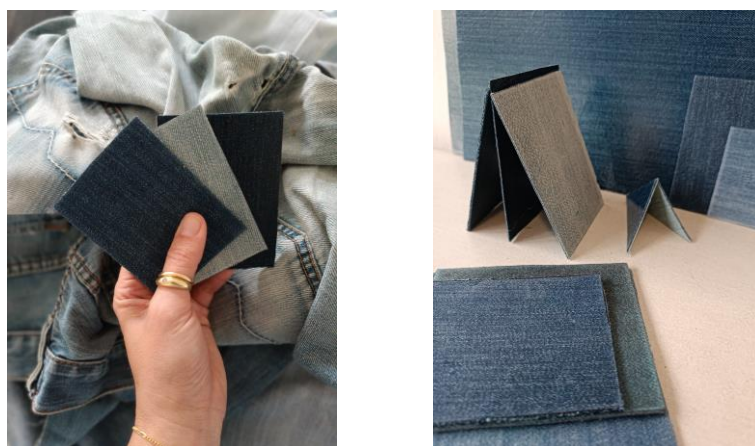
Figura 61 - Materiais com DenimHDPE e DenimPMMA após compressão, (da esquerda para a direita)
