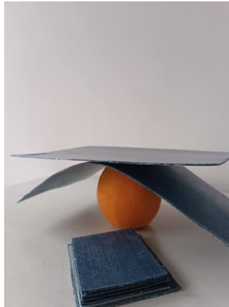
Figura 62 - Material com DenimHDPE (material mais maleável em curva) e material com PMMA (material mais rígido e com acabamento mais liso e brilhante colocado no topo) Fonte: Autora, arquivo pessoal
