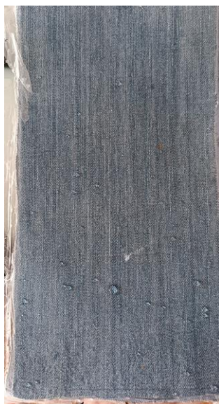
Figura 68 - Amostra DenimHDPE após Spray Tester (considerada grau 3 a 4)
