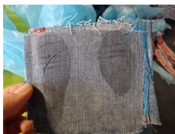
Figura 38 - parte de trás da amostra com 12 camadas (após compressão de 200N à 165°C) Fonte: Autora, arquivo pessoal
