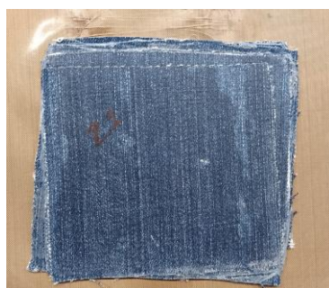
Figura 46 - Amostra 2.1 com HDPE após processo de compressão Fonte: Autora, arquivo pessoal
