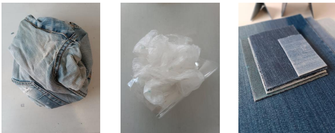
Figura 60 - Resíduo de denim, polímeros e o material finalizado (esquerda para direita)
