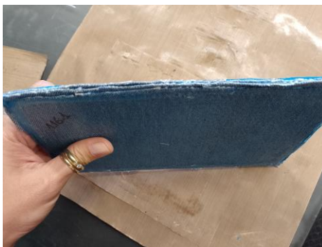
Figura 40 - Amostra 1.16.1 com 20 camadas após compressão à 168°C e 140N Fonte: Autora, arquivo pessoal
