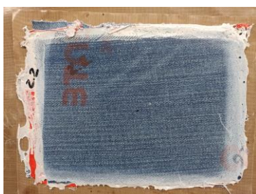
Figura 47 - Amostra 2.2 com LDPE após processo de compressão Fonte: Autora, arquivo pessoal
