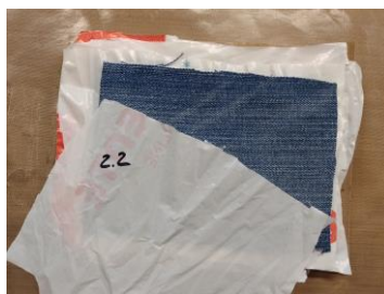
Figura 45 - Amostra 2.2 com descarte de denim e LDPE antes da compressão Fonte: Autora, arquivo pessoal
