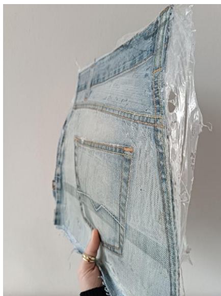
Figura 59 - Amostra de denim prensado com as costuras existentes e HDPE Fonte: Autora, arquivo pessoal
