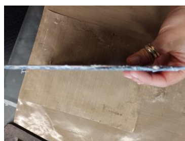
Figura 47 - Amostra 2.2 com LDPE após processo de compressão Fonte: Autora, arquivo pessoal
