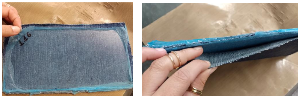
Figura 39 - Amostra 1.16 com 20 camadas (após compressão à 165°C e 140N) Fonte: Autora, arquivo pessoal
