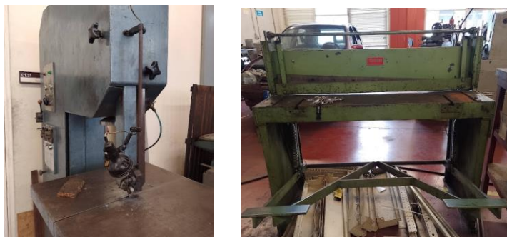
Figura 53 - Serra e Guilhotina manual do Departamento de Mecânica UM Fonte: Autora, arquivo pessoal
