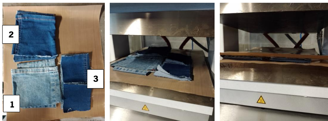
Figura 25 – Amostra 1, 2 e 3 antes da compressão Fonte: Autora, arquivo pessoal
