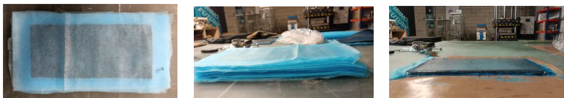
Figura 42 - Amostra com 30 camadas de denim antes e pós compressão (da esquerda para a direita)
