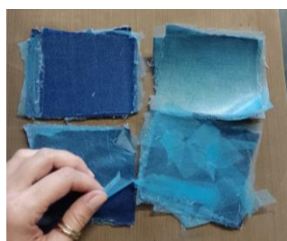
Figura 33 - Amostras 1.6, 1.7, 1.8 e 1.9 sentido horário da esquerda para direita após compressão 150°C Fonte: Autora, arquivo pessoal
