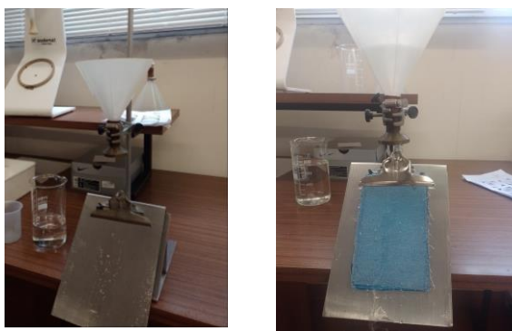
Figura 66 - Aparelho Spray Tester - permeabilidade à água Fonte: Autora, arquivo pessoal
