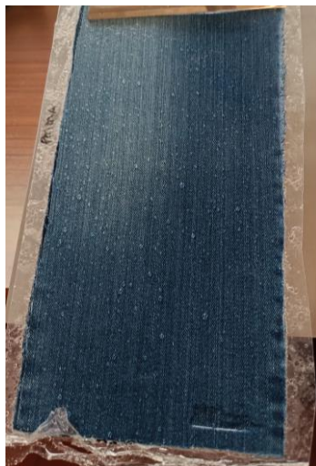
Figura 69 - Amostra DenimPMMA após Spray Tester (considerada grau 5)
