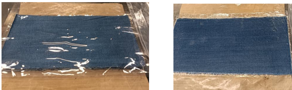
Figura 57 - Amostra DenimPMMA antes e após compressão (da esquerda para a direita) Fonte: Autora, arquivo pessoal
