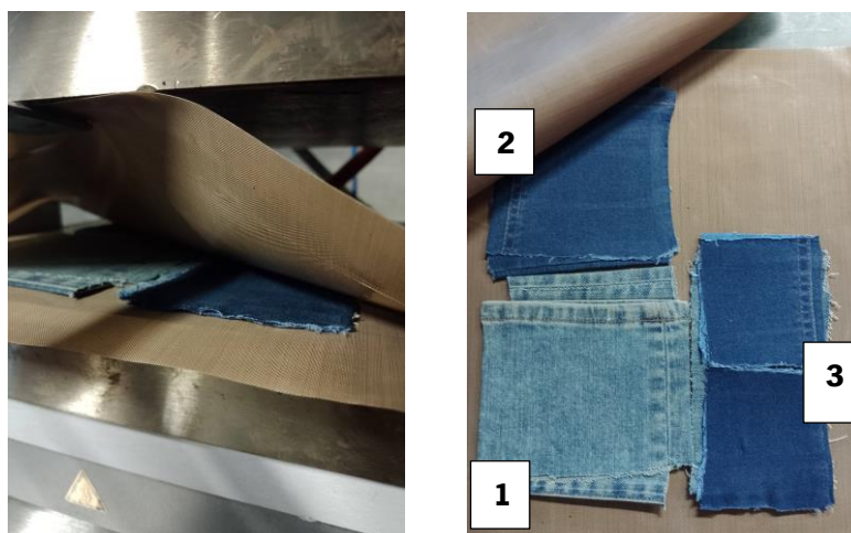
Figura 26 – Amostra 1, 2 e 3 após compressão à 200°C Fonte: Autora, arquivo pessoal
