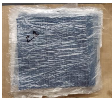
Figura 44 - Amostra 2.1 com descarte de denim e HDPE antes da compressão Fonte: Autora, arquivo pessoal
