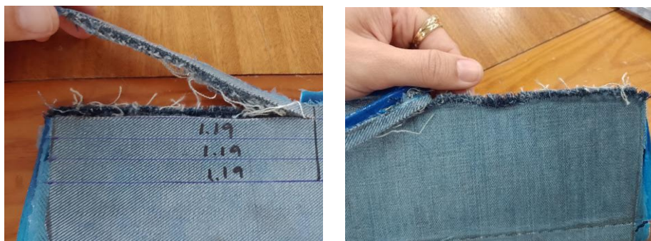
Figura 54 - Dificuldade no corte do material mais espesso Fonte: Autora, arquivo pessoal
