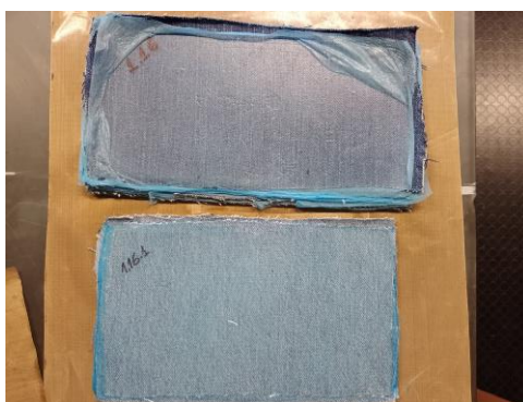
Figura 41 - Amostras 1.16 e 1.16.1 (de cima para baixo) (após compressão à temperatura de 165°C e 168°C respectivamente) Fonte: Autora, arquivo pessoal
