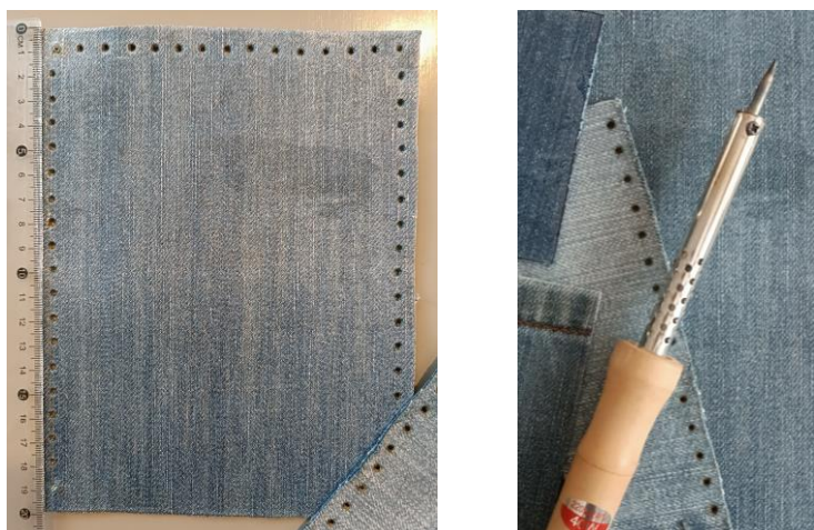
Figura 88 - Material cortado e perfurado com perfurador manual à quente Fonte: Autora, arquivo pessoal
