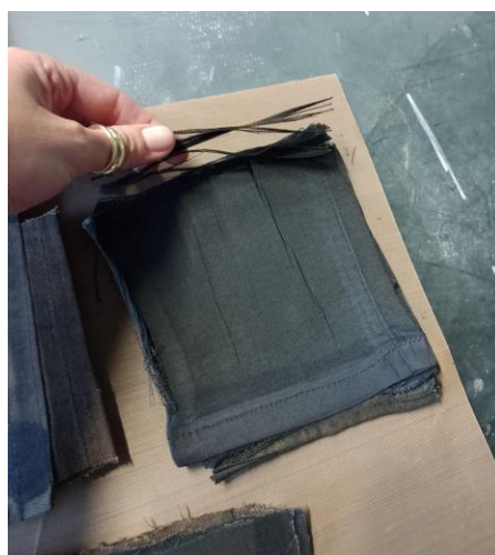
Figura 28 - Amostra com material danificado após compressão à 270°C Fonte: Autora, arquivo pessoal
