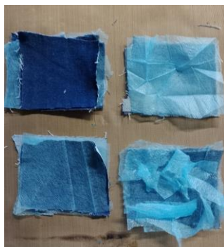
Figura 32 - Amostras 1.6, 1.7, 1.8 e 1.9 sentido horário da esquerda para a direita antes da compressão à 150°C Fonte: Autora, arquivo pessoal
