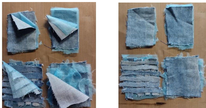
Figura 30 - Amostras de denim e polímero antes da compressão (Amostra 1.2, 1.3, 1.4, 1.5 sentido horário da esquerda para a direita) Fonte: Autora, arquivo pessoal
