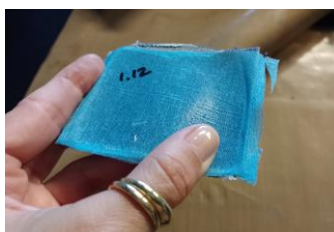
Figura 35 - Amostra 1.12 após compressão à 155°C Fonte: Autora, arquivo pessoal
