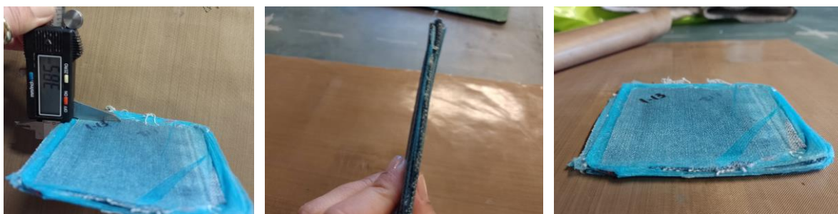
Figura 37 - Amostra 12 camadas após compressão de 100N à 160°C Fonte: Autora, arquivo pessoal
