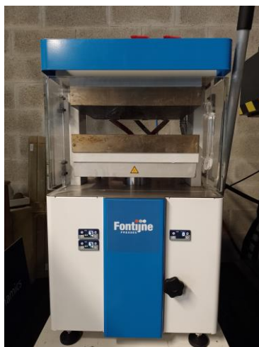
Figura 23 - Compression Moulding Fonte: Autora, arquivo pessoal
