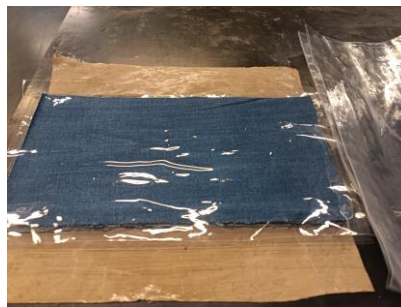
Figura 50 - Amostra 3.1 com resíduo de denim e PMMA antes da compressão Fonte: Autora, arquivo pessoal
