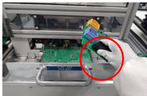
Figura 71 – Colisão da placa Eletrónica com a lateral da gaveta do equipamento Press-Fit .
