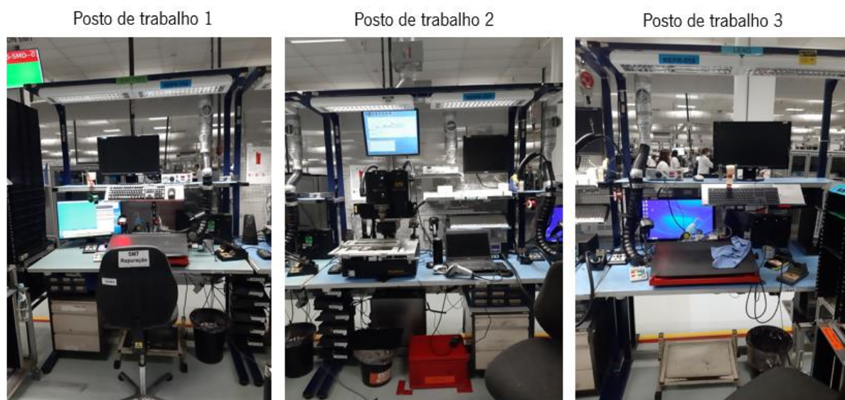
Figura 116 – Situação atual das bancadas de retrabalho de SMT.
