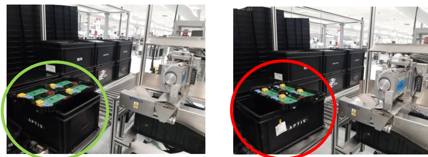
Figura 67 – Exemplificação do posicionamento correto e incorreto da caixa e do tabuleiro, em Singulation , respetivamente.
