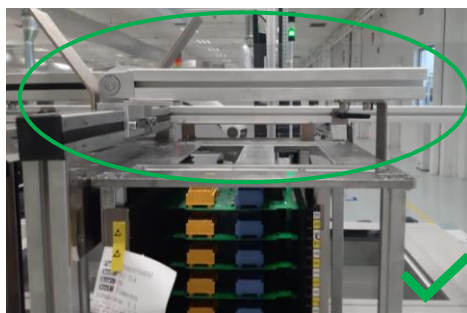
Figura 89 – Depois da implementação de um suporte para fixar os containers .
