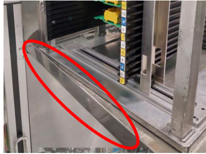
Figura 68 – Identificação da chapa metálica da rampa existente no processo Singulation .
