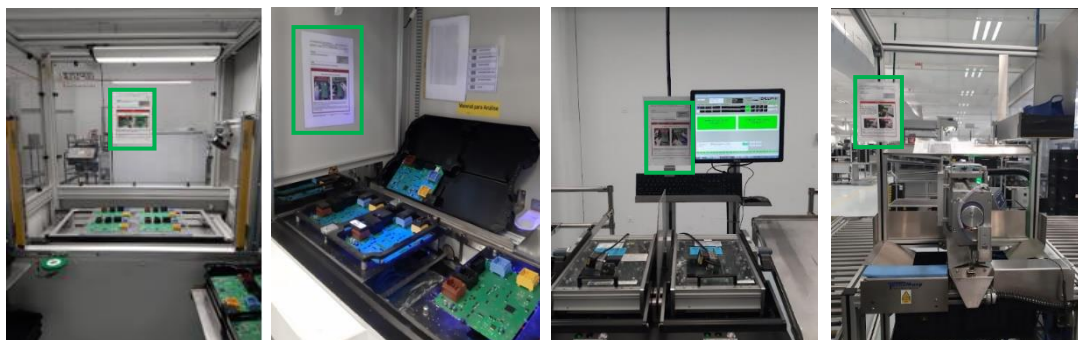
Figura 92 – Implementação de Quality Alerts nos processos PCB Cleaning , Coating , MOL e Singulation , respetivamente.
