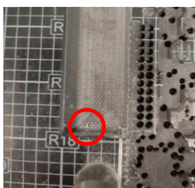
Figura 73 – Identificação do componente C324 na base do ICT.
