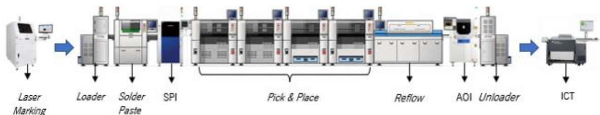
Figura 18 – Principais processos da secção SMT.
