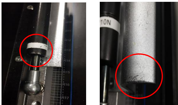
Figura 60 – Marcas de desgaste nos amortecedores e pegas do equipamento ICT, respetivamente.
