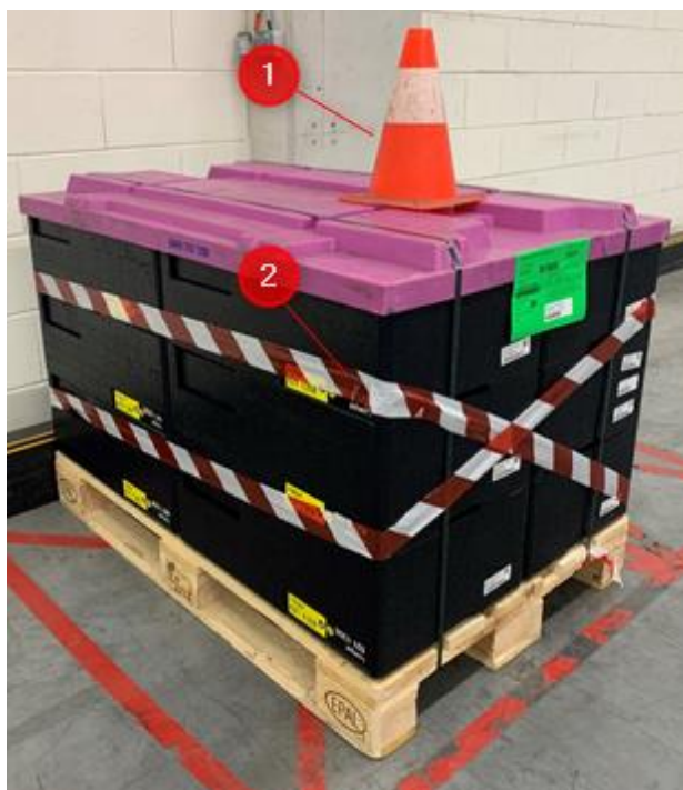
Sinalização de uma paleta bloqueada fisicamente
