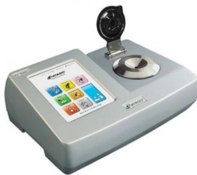
Figura 19 - Equipamento RX-5000i, utilizado para medir a percentagem de teor de sólidos solúveis das amostras. Imagem retirada do site oficial da Cetec, 2024.
