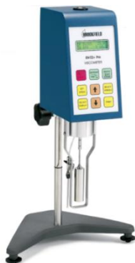
Figura 17 - Equipamento Brookfield DV-II+Pro, utilizado na medição da viscosidade das amostras recolhidas. Imagem retirada do documento de utilização, publicado por Fullbrook, 2015.
