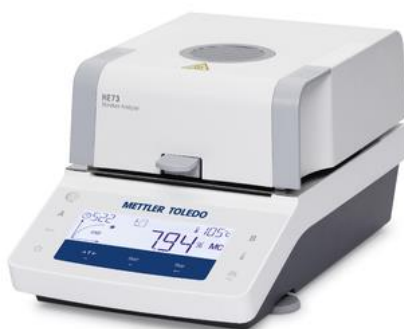
Figura 18 - Equipamento Halogen Moisture Analyzer HE73, utilizado na medição do teor de sólidos totais das amostras recolhidas. Imagem retirada do site oficial da Mettler Todelo, 2024.
