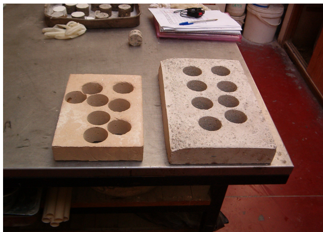
Fig. 2.16. – Lajetas de Geobetão e Betão
