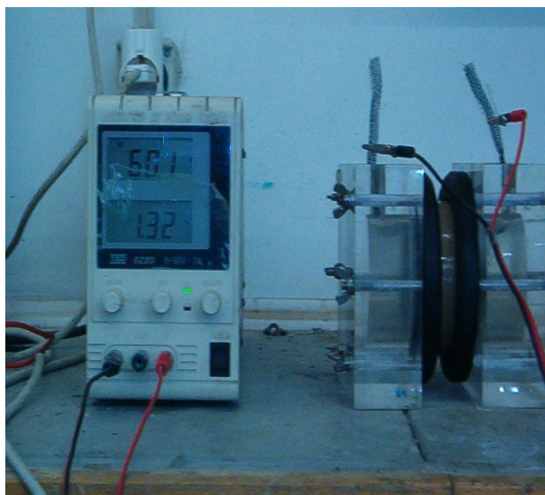
Fig. 2.18. – Ensaio dos Cloretos – Pormenor
