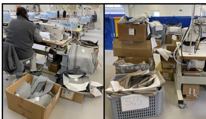
Figura 42- Acumulação de caixas e corredores de circulação ocupados.
