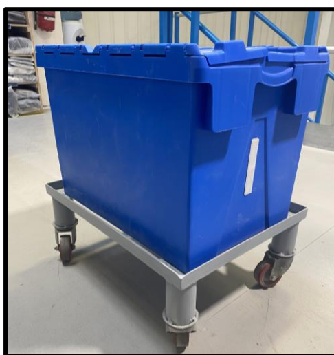
Figura 58- Protótipo de um carrinho para a deslocação de material.
