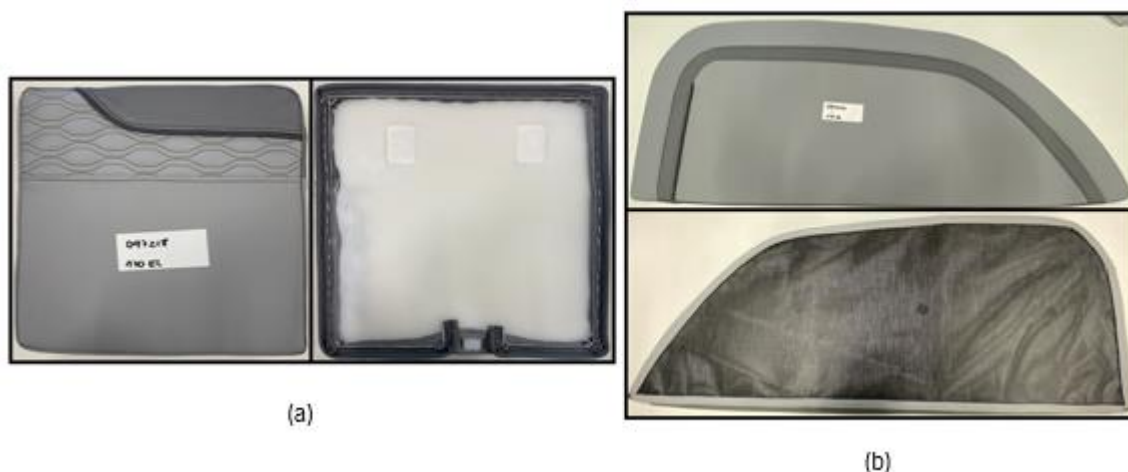
Figura 32- (a): Exemplo de um encosto agafado; (b): Exemplo de um assento agafado.
