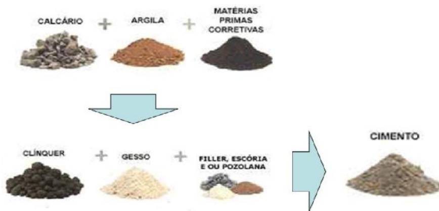
Figura 1 – Alguns constituintes do cimento
