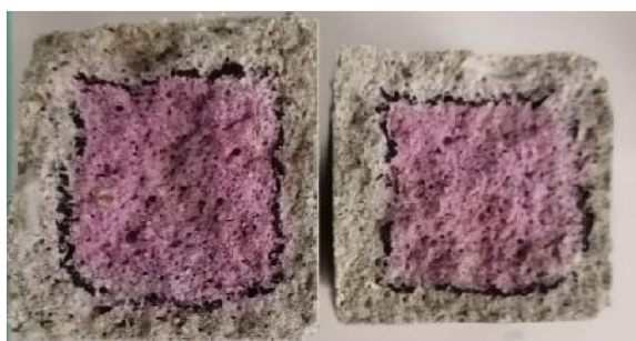
Figura 27 - PV-C1(controlo): Teste de fenolftaleína após 28 cura tradicional + 7 dias ambiente natural
