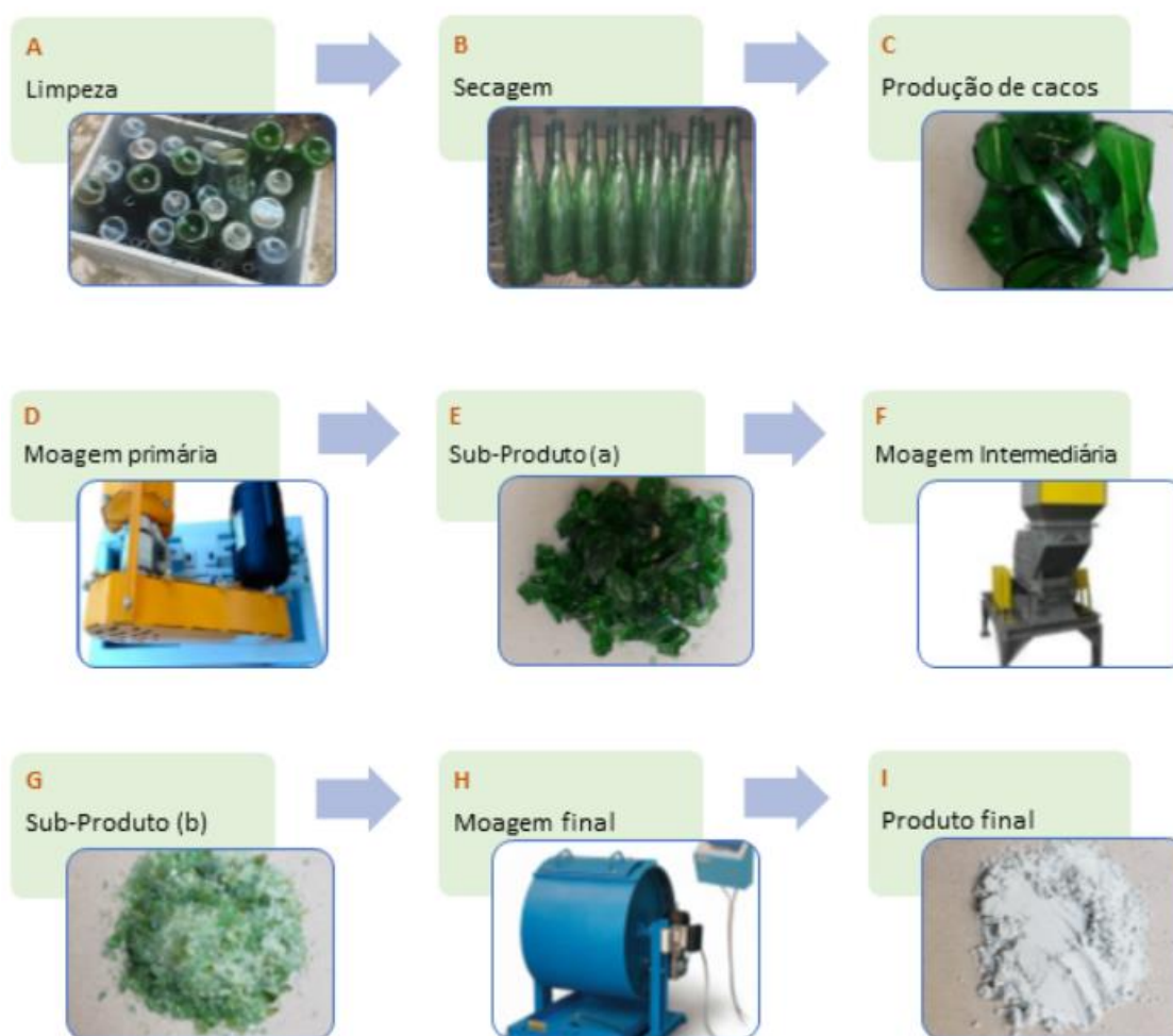
Figura 8 - Procedimentos para moagem de vidro (Moreira, O. 2023)
