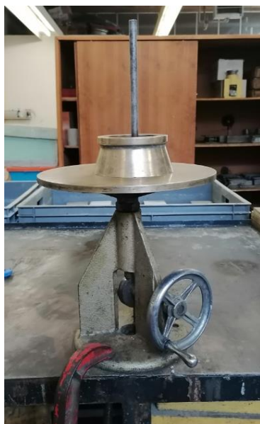
Figura 19 - Mesa de espalhamento - ensaio de trabalhabilidade
