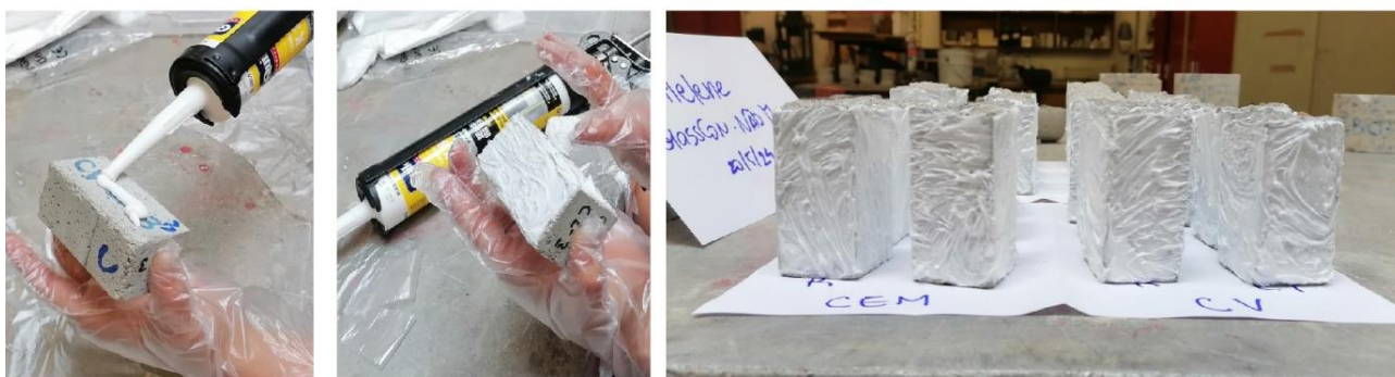
Figura 23 - Isolamento para absorção de água por capilaridade
