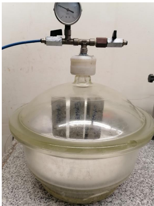
Figura 18 - Efeito da condensação no exsicador
