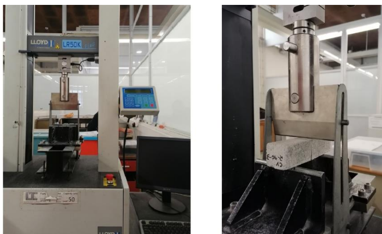
Figura 21 - Prensa universal Lloyd utilizada para realização do ensaio de resistência à flexão
