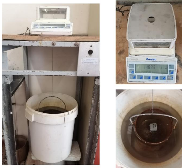
Figura 25 - Ensaio para absorção de água por imersão
