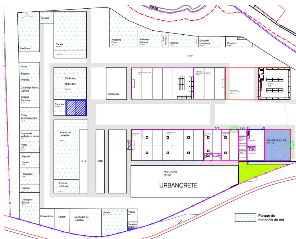
Figura 12. Parque de materiais exterior do entreposto de Braga (Autoria própria)
