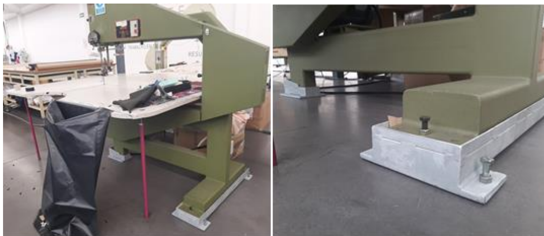
Figura 32 - Serra de fita com base para subida da mesa de apoio
