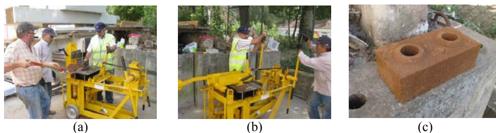
Figura 1: Produção de BTCs: (a) colocação da mistura no molde; (b) prensagem do bloco; (c) BTC pronto para a secagem.
